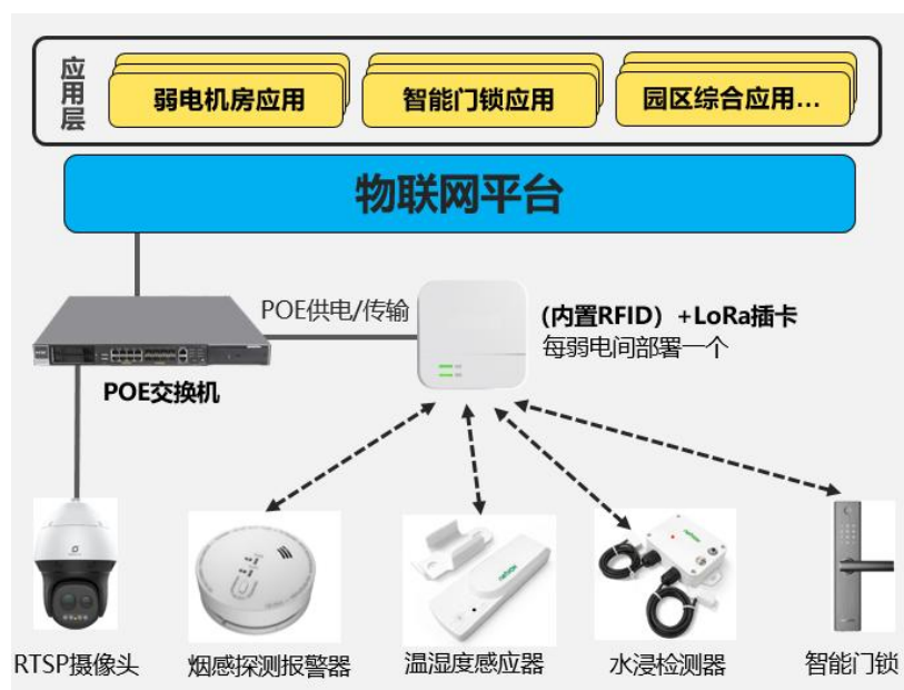
图 6 机房改造架构图
